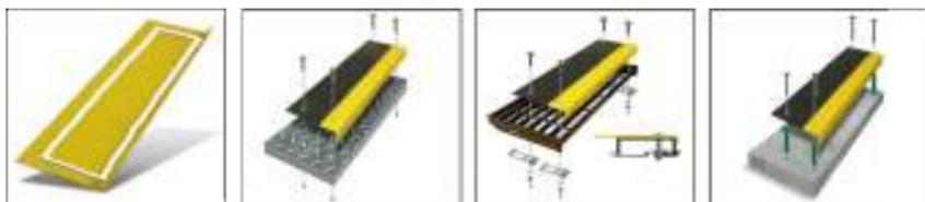
※ネジ、或いは接着剤で簡単に設置していただけます。(併用推奨)
